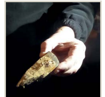
Tilmann Marstaller zeigt den Holznagel, der ohne Funktion im Balken steckt. Das Querholz ist längst abgesägt, das der Nagel auf dem Floß hielt.
